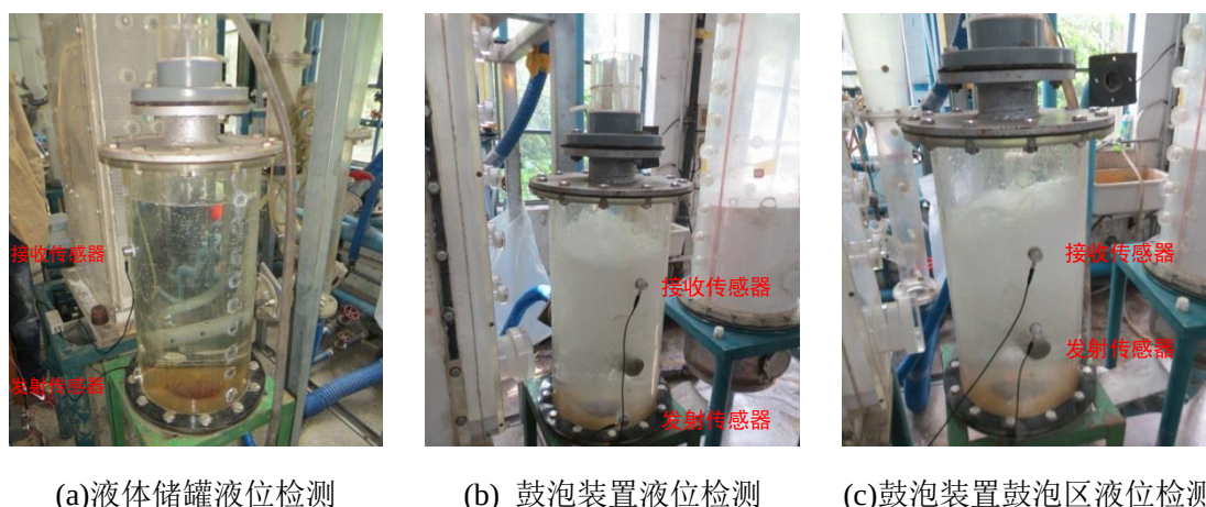
图 7 超声波液位检测实验装置实物图
