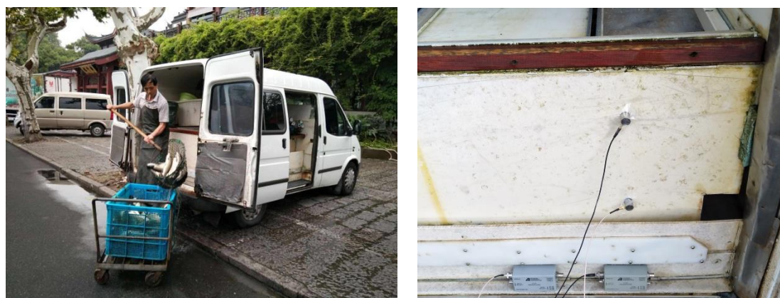
图 15 “楼外楼”活鱼运输箱液位检测实物图
