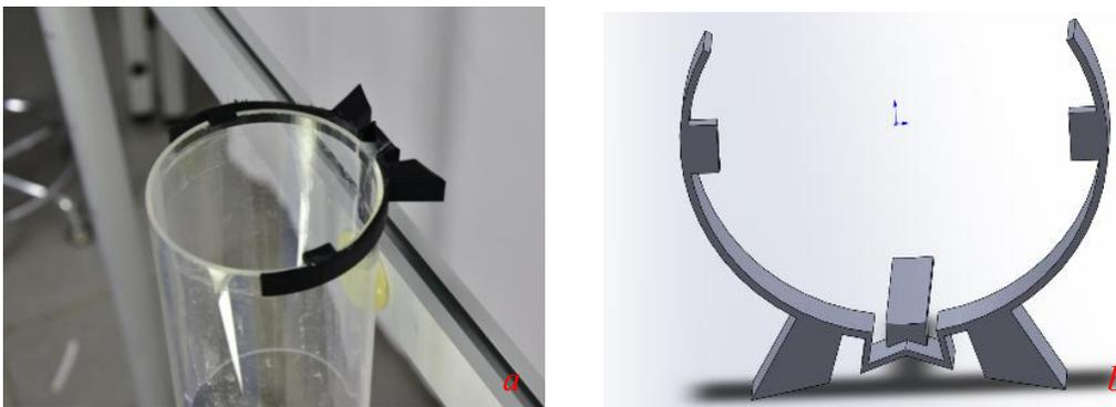
图29: 释放装置。a. 定制亚克力管恰能保证杯子以低阻力滑落。b. 3D打印释放卡止装置, 能减小释放时的人为扰动, 保证释放时体系左右平衡。
