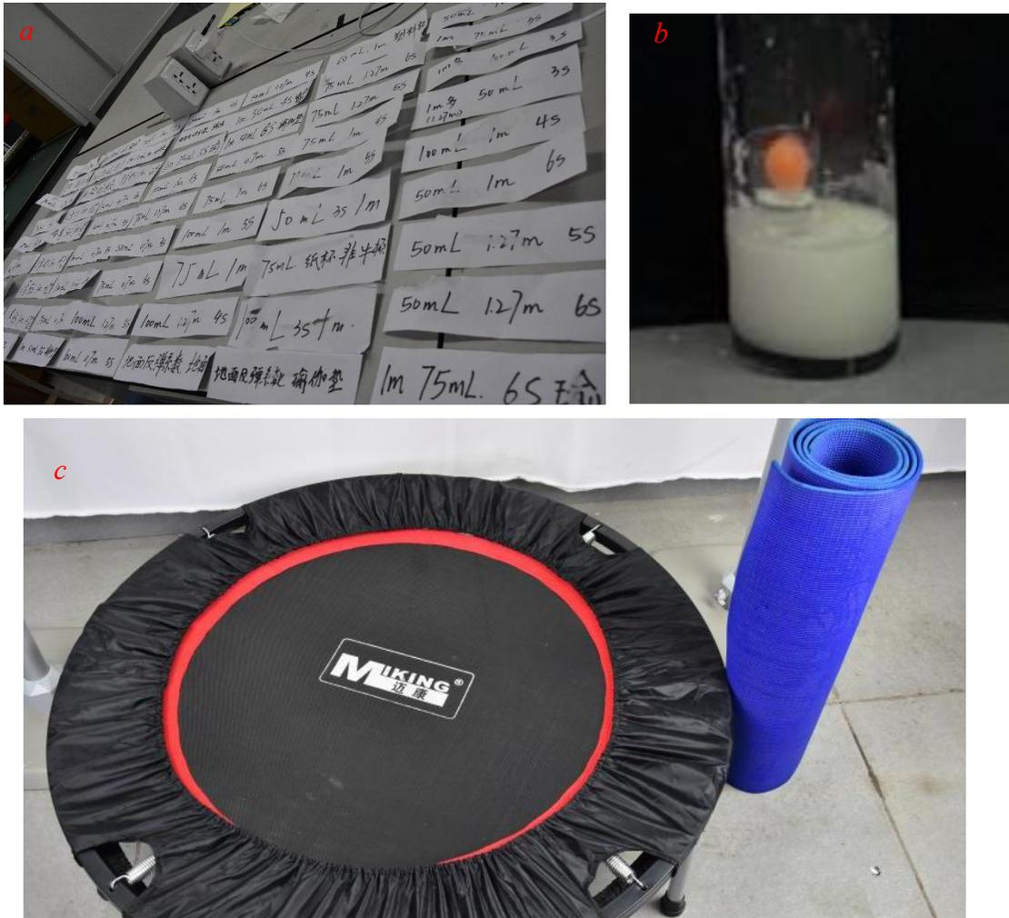
图30: 水量, 释放高度, 转速对比实验。a, 不同参量的记录标签; b. 非牛顿流体碰撞面; c. 蹦床碰撞面和瑜伽垫碰撞面。
