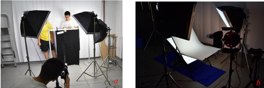
图28: 定量实验系统。a. 反弹速比测定系统; b. 下落过程、碰撞过程局部观测系统。
