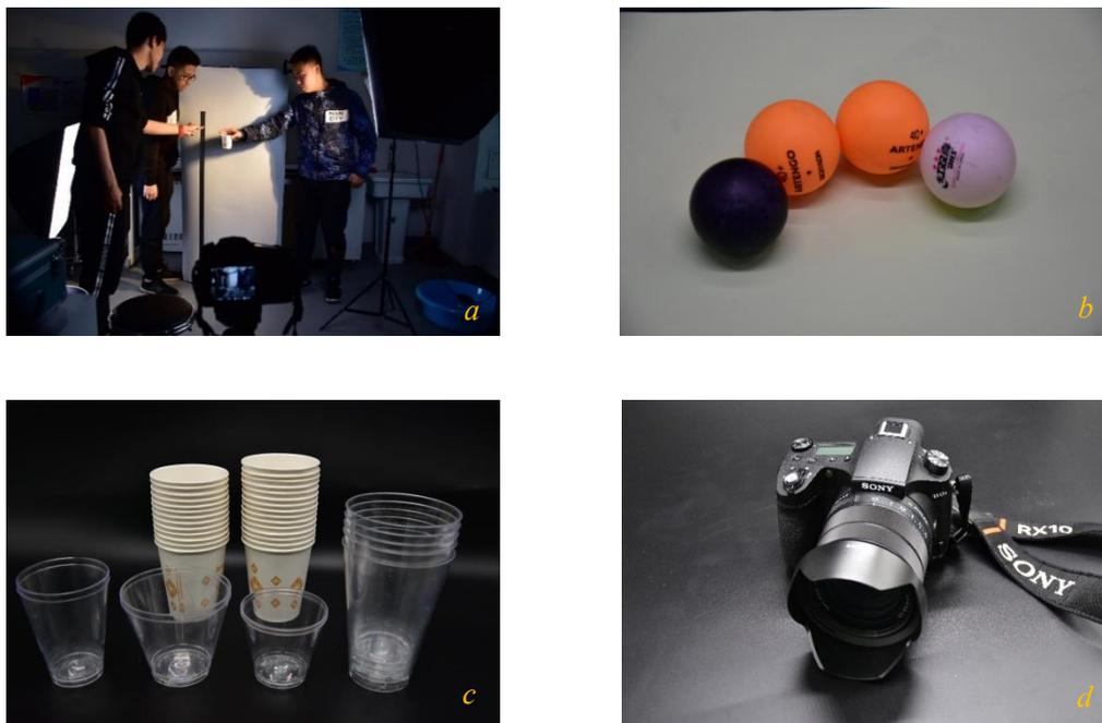
图4: 在预实验中主要采用的实验装置和设备。a. 实际实验场景。图中尺子用于相机像素点定标, 摄影灯用于增加光强, 提高视频清晰度。b. 我们所采用的乒乓球种类和型号。c. 75 盎司(200ml) 一次性纸杯(定量实验)和各种型号塑料透明杯(观察实验)。d. 高速摄影机。每秒能够采集 1000 帧。<sup>1</sup>
