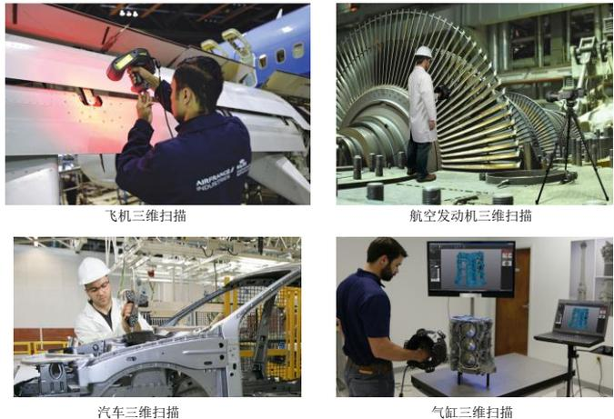
图3-2 工业级光学法三维扫描设备的应用
