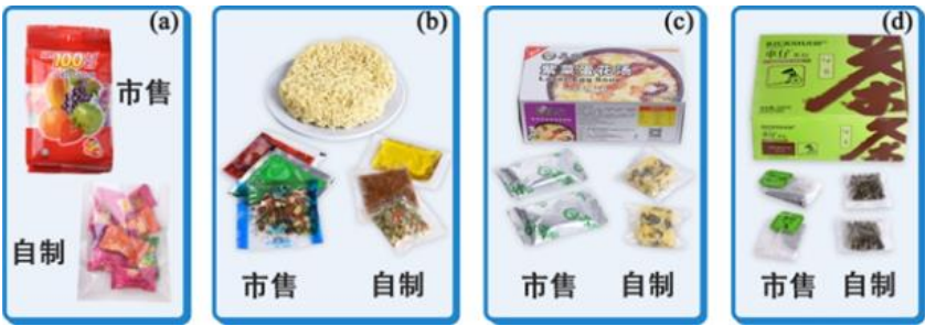
图 3-8 半乳甘露聚糖-纳米纤维素复合膜材料手工制作的包装袋
