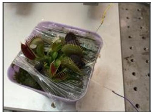
图5 测试捕蝇草生物电信号操作图
