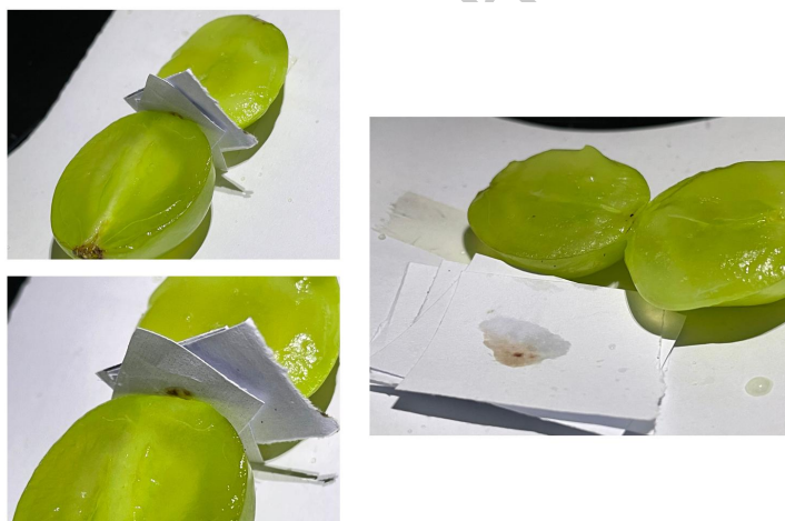
图 4.12 葡萄二聚体由 4 层 A4 纸隔开。可以看到较为明显的 plasma 现象的产生。
