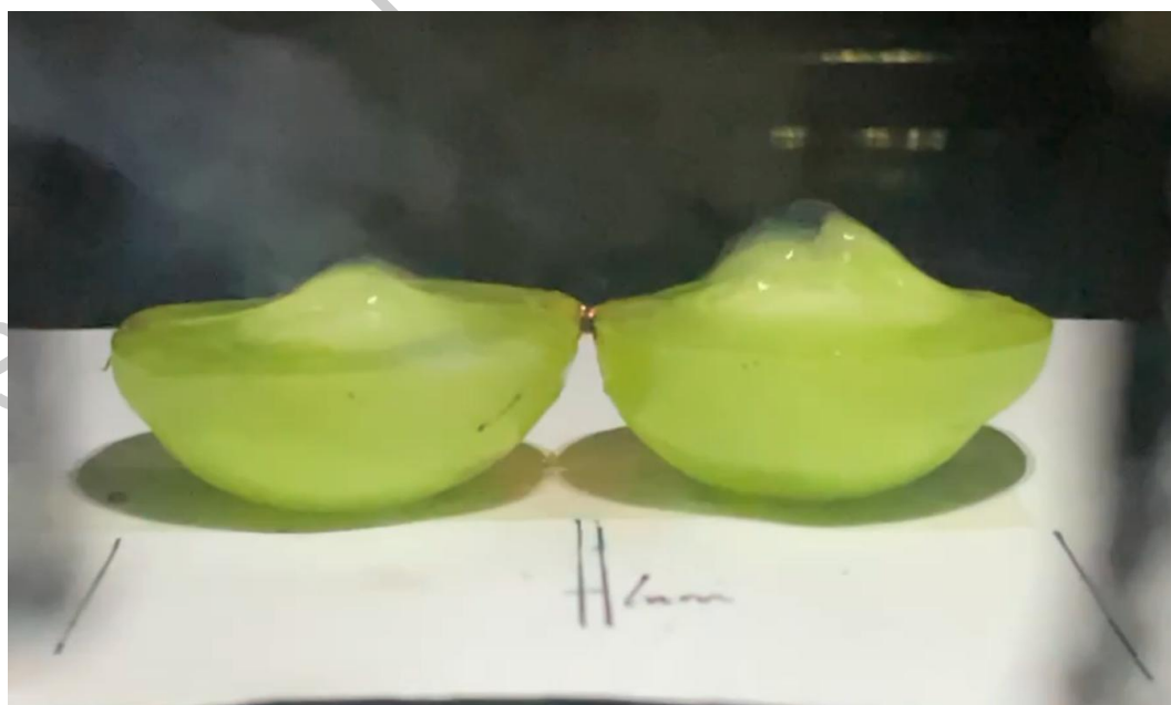
图 4.8 葡萄半球二聚体 (Gap=1 mm) 在微波炉中加热后，连接处被烧毁，但残存火炭状灰烬。
