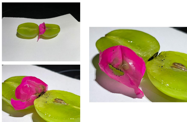
图 4.11 葡萄二聚体由 1 层橡胶膜隔开，同样可以看到明显的 plasma 现象的产生。
