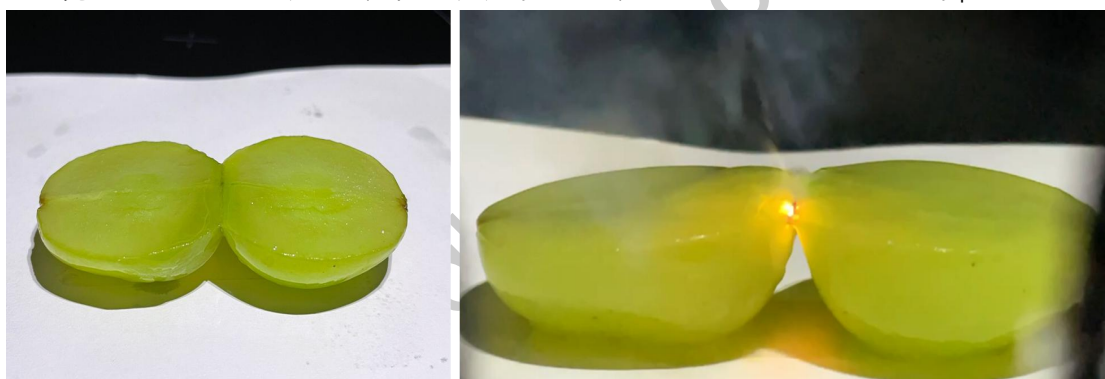
图 5.2 冰葡萄 plasma 实验。(左) 加热前与 (右) 加热中。可以观察到明显的 plasma 现象。
