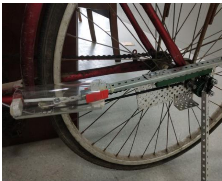
图 25 后部插销结构
