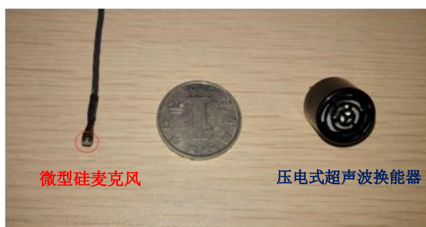
图 2.8 可插入蝙蝠模型耳道内的微型硅麦克风
