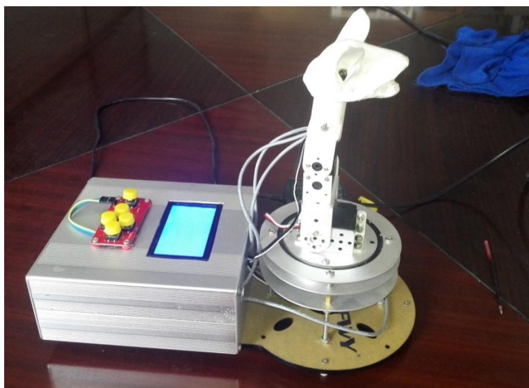
图 2.6 自制的仿生蝙蝠声呐实验装置
