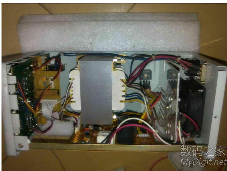
图 17 典型的机械—电子式可调直流稳压电源实物图
