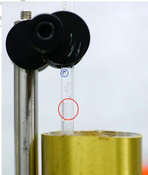
图 8 使用苏打水进行实验时产生的普通气泡与巨大空腔
